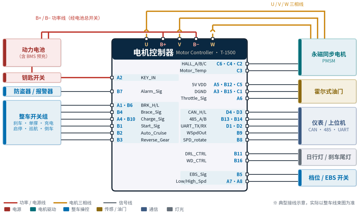
图 10-1 T-1500 整车典型接线示意图
